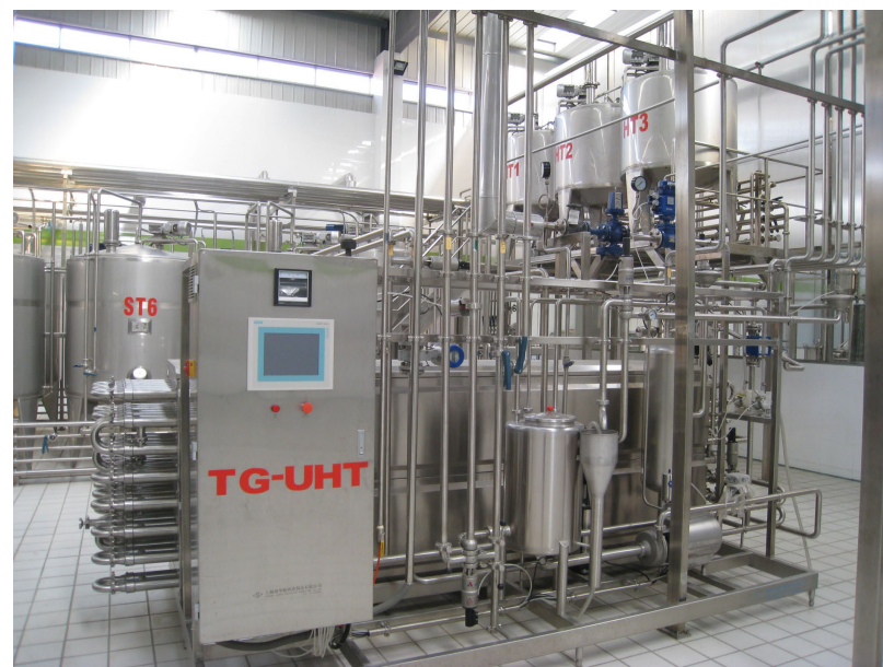
乳品加工企业的套管式杀菌机 图片：czagri.gov.cn
